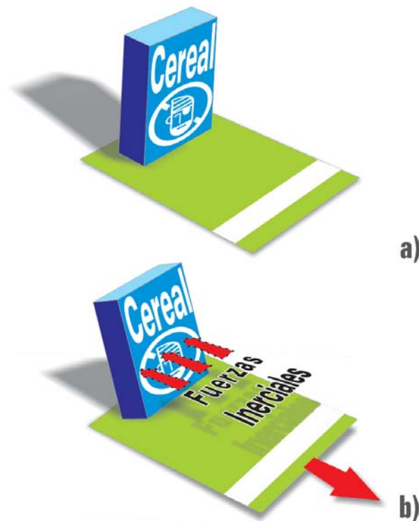
Figura 7. Si imaginamos una caja de cereal colocada sobre un tapete, la cual se encuentra en reposo (a) y en determinado momento movemos el tapete, es claro que la caja trata de voltearse sin que la estemos empujando directamente. Este mismo resultado lo podríamos lograr aplicando las fuerzas horizontales indicadas en (b), las cuales son justamente las denominadas fuerzas inerciales (Ref. 3).
