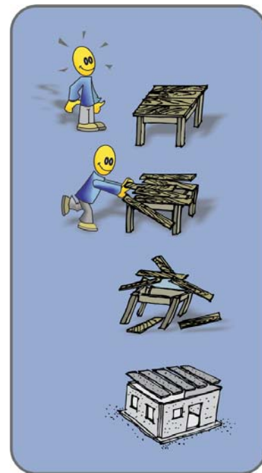
Figura 16. Si las tablas que conforman la mesa estuvieran sueltas entre sí, al empujarlas cada una se desplazaría en forma diferente. Si las unimos de tal forma que estén obligadas a desplazarse en conjunto, decimos que hemos logrado que la tapa de la mesa se comporte como un diafragma.
