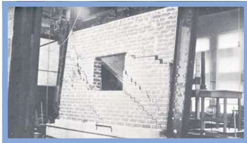
Figura 27. Con el fin de complementar los estudios teóricos, en los laboratorios de todo el mundo se ensayan paredes, tratando de considerar el mayor número de variables y poder de esta forma proponer metodologías de diseño (Ref. 12).
